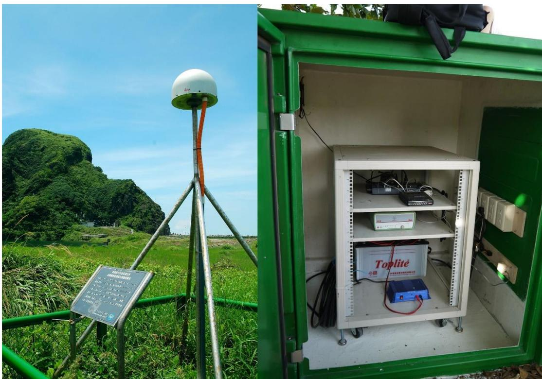
圖 3-2.1 GPS 連續追蹤站外觀（左圖）及儀器箱置放儀器設備圖（右圖）。白色天線罩內為天線所在位置，隨時處於連續接收衛星訊號，資料即時透過網路傳至控制室處理與解算。
