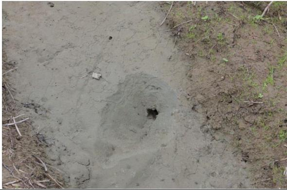
圖 2-2.11 臺南市新化區北勢里一帶的噴砂現象以孔隙噴砂為主。
