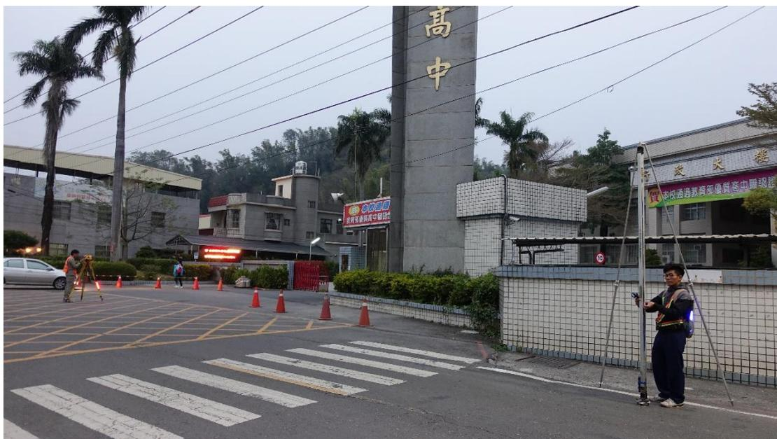
圖 3-3.3 本次地震後水準測量施測情形，觀測時以電子水準儀及鋼尺施測，利用逐站觀測前、後視標尺求得高程差方式，累積得到二水準點間的總高程差，觀測精度符合一等水準作業規範的要求。
