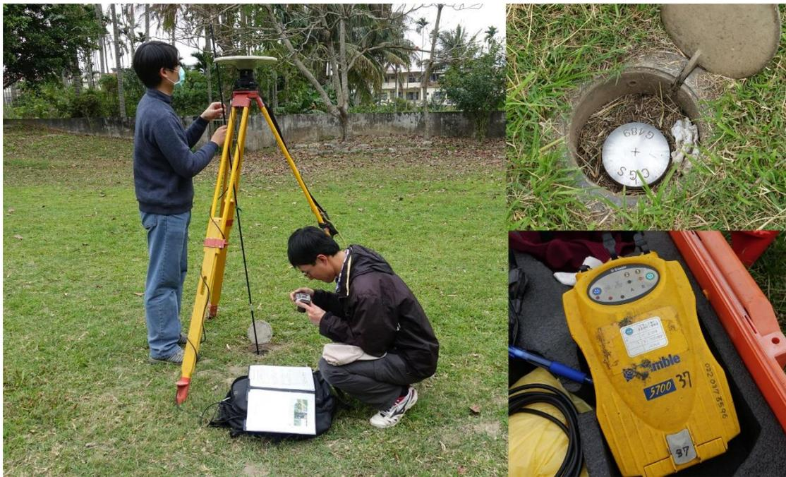
圖 3-3.1 本次地震後 GPS 移動站施測與檢測作業情形。右上圖為監測點地面鋼標頭、右下圖為衛星定位接收儀。觀測人員須使用量棒量測天線的斜高，以利將天線盤定位坐標化算至地面鋼標十字刻度位置，不同年度間的坐標變化可以顯示鋼標的位移情形。
