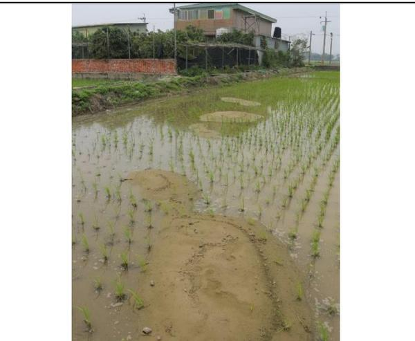
圖 2-2.14 臺南市新化區太平里烏鬼厝一帶群聚性的噴砂現象，噴砂錐約呈 N70~80°E 線形排列。
