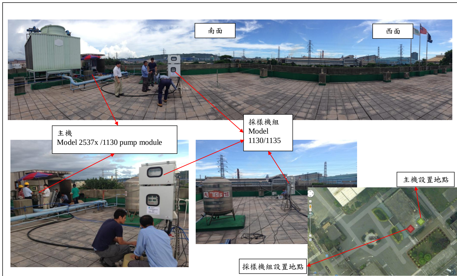
圖 5-9 本計畫汞自動連續監測設備架設情形
