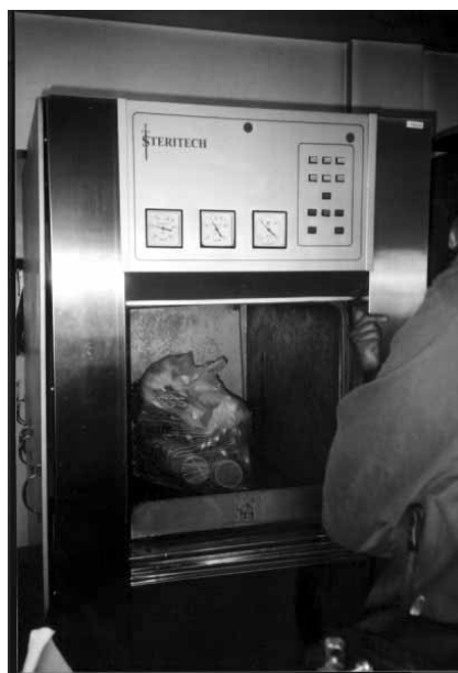
一個操作中的小型高壓蒸汽滅菌鍋。 © Photo courtesy of Neil Tangri
