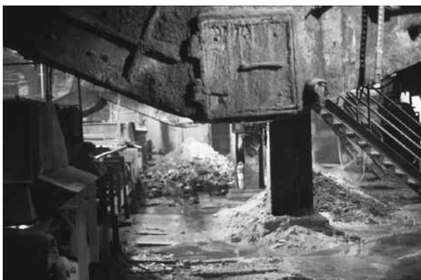
由爐子落下的底灰與從靜電集塵器落下的飛灰。攝自美國賓夕法尼亞州的哈利斯堡焚化廠。
