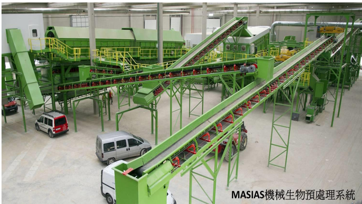
圖 28. 機械生物處理系統 (以西班牙 MASIAS 某廠為例)
