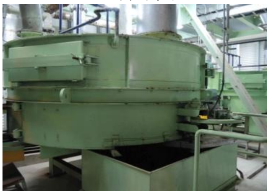
飛灰固化混鍊機
