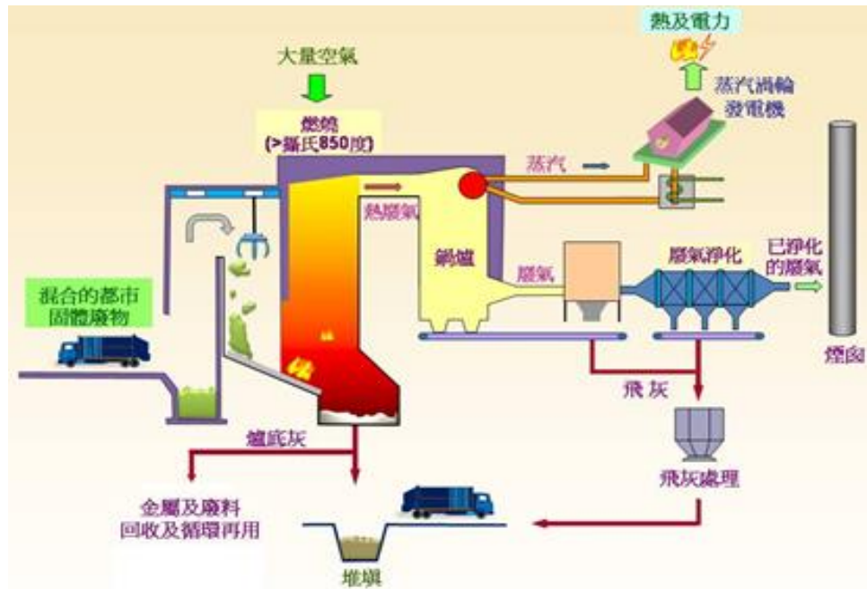
圖 5.1-1 典型垃圾焚化廠處理流程圖
